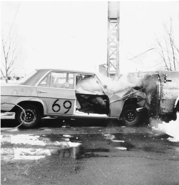
Mercedes-Benz erprobt erstmals die Wirkungsweise des Airbags bei einem Frontalaufprall
