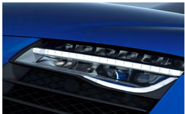
Weltpremiere im R8 LMX kam 2014 erstmals in einem Serienfahrzeug das Laserfernlicht zum Einsatz
